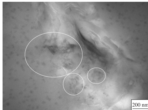
Figura 2. Micrografia de microscopia eletrônica de transmissão (TEM) de borracha natural com celulose II e 2 phr de montmorilonita.
